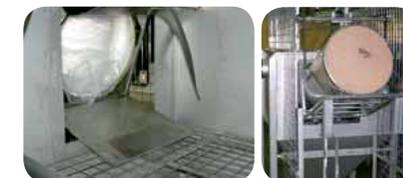
La montée et le positionnement du fût dans la cabine est réalisée par l'élévateur intégré à la cabine
