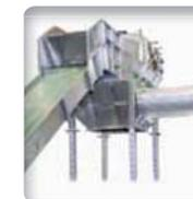
**Support de réhausse machine** afin que les opérateurs puissent accéder aux différentes portes de la machine
