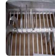
**Emoteur intégré** permet à la machine de traiter des poudres mottées. Les pales assurent le passage des mottes à travers une cible calibré.
