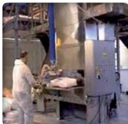
▶ Alimentation de la machine par manipulateur
