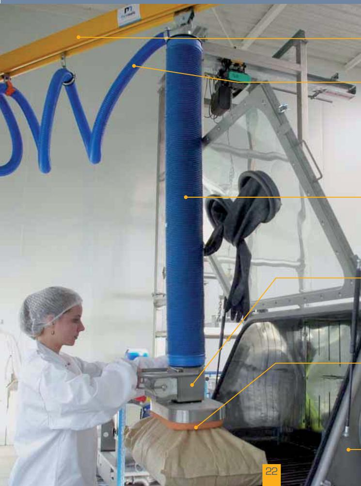
Potence sur fût triangulée hauteur sous fer 3 m. pour assurer une course de levage de 1 700 mm
