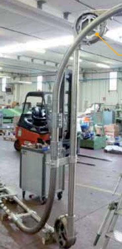
Roue d'envoi d'angle à encoches permettant l'indexage des disques et ainsi la mise en mouvement du câble
