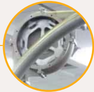
Roue d'envoi d'angle à encoches permettant l'indexage des disques et ainsi la mise en mouvement du câble
