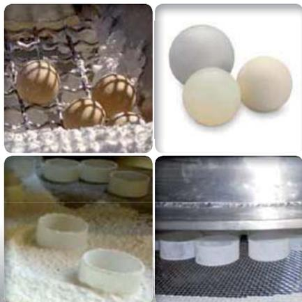
▶ Les balles sont placées sous la toile dans des «cages» prévues à cet effet. Les balles sautent et amplifient ainsi les vibrations de la toile.
