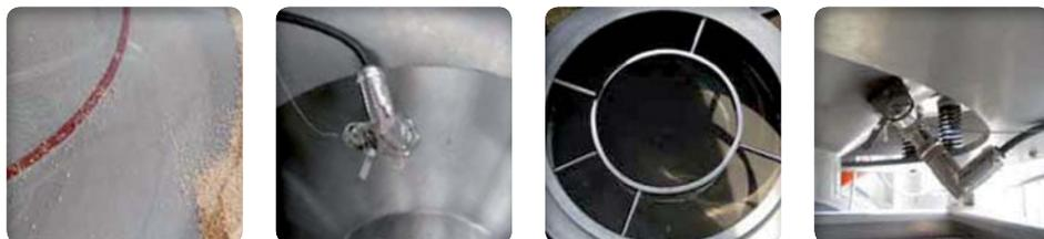
L'ultrason est spécialement conçu pour les grilles fines < 200 µm. Selon les dimensions du tamis 450, 600 ou 900, il peut être nécessaire d'implanter deux générateurs.
