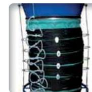
Câbles de levage extérieurs au flux du produit
