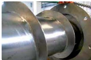
2. Les vis ayant un diamètre d'arbre surdimensionné ne nécessitent pas de paliers intermédiaires et possèdent une distance de transfert importante. Pour les produits abrasifs, l'alternative au palier intermédiaire est le surdimensionnement de l'arbre.
