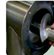
➤ Facilité de maintenance grâce à l'extraction rapide de la spire de l'auge
