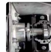
▶ **Paliers d'extrémité** avec groupe d'étanchéité de l'arbre
