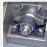
▶ **Palier d'extrémité** avec roulement déporté
