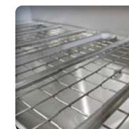
▶ **Crible intérieur de support des sacs avec barres de glissement** permettant une aide au positionnement du sac et une protection contre les corps étrangers par crible maillé en position inférieure
