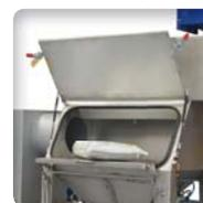
▶ **Porte d'accès montée sur vérin à gaz** : un accompagnement à l'ouverture et à la fermeture
