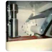
Le rouleau de maintien permet de traiter des sacs dont le poids est inférieur à 15 kg
