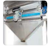
La goutotte vibrante permet de canaliser le flux produit pour l'introduction dans le process en amont
