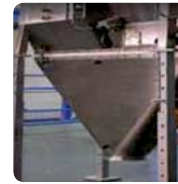
Goutotte statique inox pour le transfert des poudres lors du process
