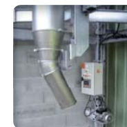
➤ Crochet de tension du big bag et bouche de remplissage interne
