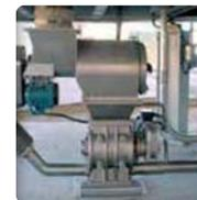
▶ **Corps** en fonte ou en acier inoxydable AISI 304L/316L
