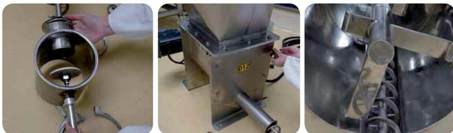
Certaines applications nécessitent un nettoyage fréquent des doseurs que ce soit pour des changements de matières et/ou dû à des contraintes d'allergènes, pigments, etc...
