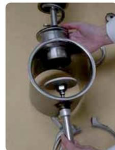
► Le clapet pneumatique assure l'arrêt net du dosage et évite tout risque de remontée d'humidité.
