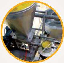
Le doseur volumétrique permet de réaliser des dosages précis d'une large variété de produits vrac. Le dosage des ingrédients est effectué au travers d'une vis de dosage qui transfère le volume à doser. La vitesse de rotation peut être asservie par un variateur de fréquence. La précision de dosage est de 7 à 8%.
