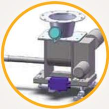
Le doseur pondéral permet d'incorporer automatiquement des produits pulvérulents ou en vrac par batch ou en continu. Les doseurs sont montés sur une plateforme stable avec un système de pesage très performant. Le système fonctionne par gain ou perte de poids et permet d'atteindre une précision de 1%.
