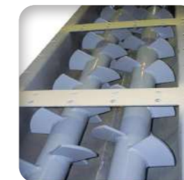
► Auto-nettoyage des rotors grâce au montage sécant
