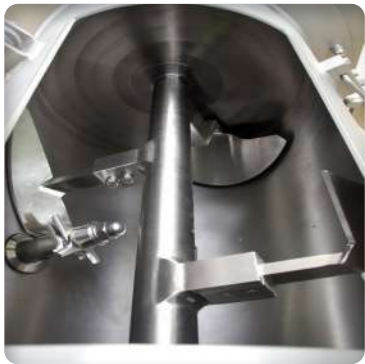
➤ Vue intérieure du mélangeur avec pale et chopper en finition inox
