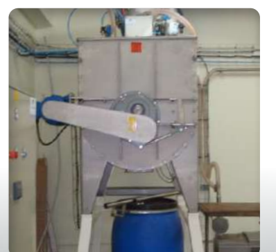
► Mélangeur avec moteur déporté
