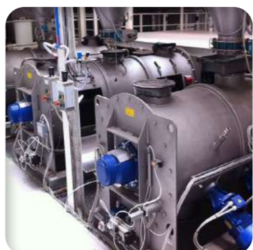
➤ Mélange en batterie pour une production élevée
