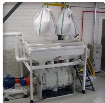
➤ Chargement direct du mélangeur par big bags
