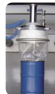
Joint gonflant pour un remplissage totalement confiné
