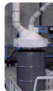
Anneau de dépoussiérage pour une aspiration des fines
