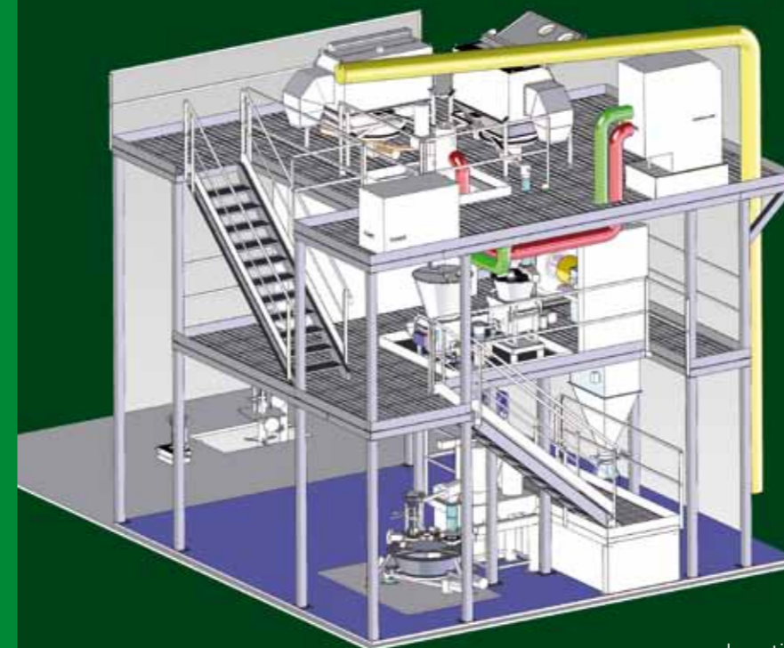
Process d'incorporation et de préparation de polymère
