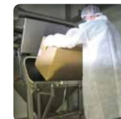
▶ **Déconditionnement carton** : l'ouverture de la station de vidange permet le déconditionnement de différents types de contenants, sacs, cartons... D'un point de vue ergonomique, la tablette relevée permet de poser et de vider le carton sans effort
