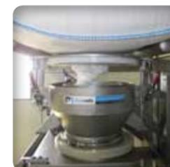
▶ **Tube de connexion** (selon version) : permet d'effectuer une connexion totalement étanche entre le big bag et la station de vidange. Le vérin pneumatique permet à l'opérateur d'ajuster la hauteur de connexion pour s'adapter aux différents types de big bags
