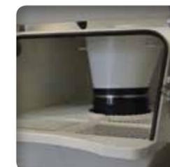
▶ **Tube de confinement** : assure un confinement du flux produit lors de la phase d'ouverture de la manchette de vidange et offre à l'opérateur plus d'ergonomie et de sécurité pour le vidage des sacs
