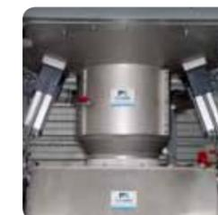
▶ **Massage plateau de dépose** : l'écoulement du produit est optimisé par la mise en place d'un système de massage pneumatique. Des vérins pneumatiques fortement dimensionnés et implantés en partie basse du big bag cassent les voûtes et brisent la prise en masse
