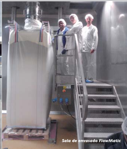
Tolva equipada con limpieza In situ e Inspección
