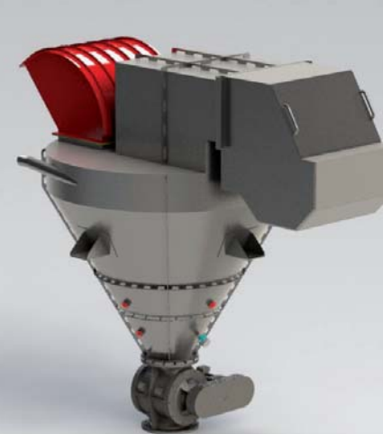
Representación SolidWorks y ciclofiltro Atex para el polvo de almídon
