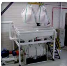
➤ Chargement direct du mélangeur par big bags
