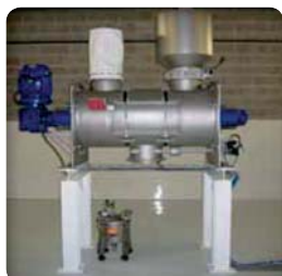
➤ Skid de mélange de laboratoire avec introduction de liquide
