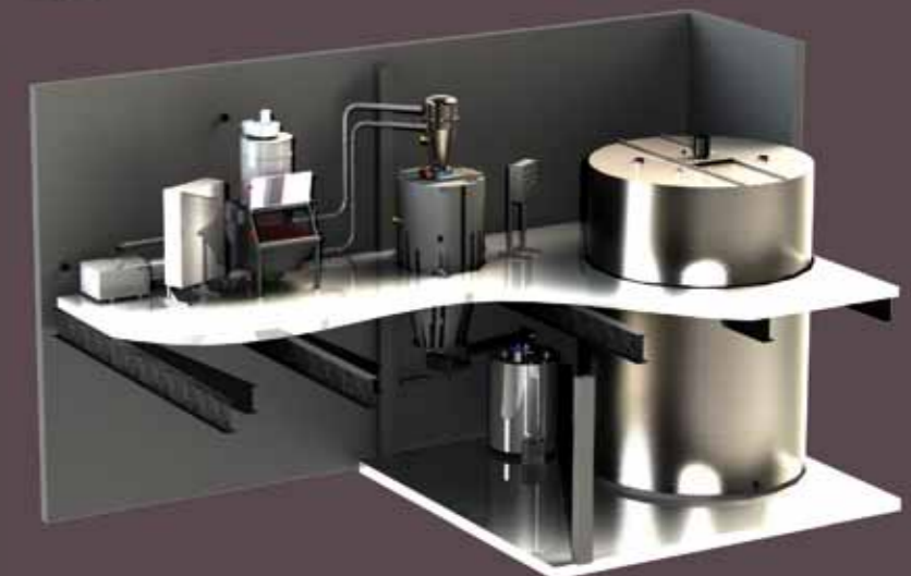
Skid de stockage et de dissolution
