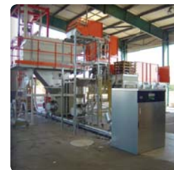
▶ Ligne de craquage de sacs chez un fabricant de polyéthylène
