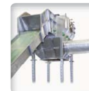
Support de réhausse machine afin que les opérateurs puissent accéder aux différentes portes de la machine
