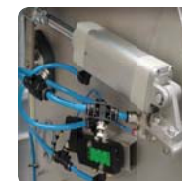
▶ Vérin pneumatique de découpe avec accumulateur pour une découpe plus efficace
