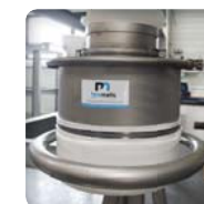
➤ L'anneau de serrage permet à l'utilisateur d'annuler toutes contraintes dimensionnelles des « ouvertures » de sacs
