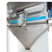
La goulotte vibrante permet de canaliser le flux produit pour l'introduction dans le process en amont
