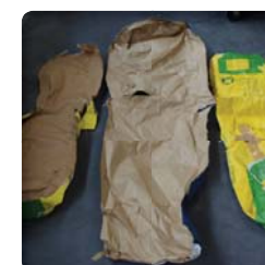
▶ Les sacs sont découpés sur 3 faces pour une ouverture totale et une vidange intégrale
