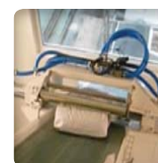
Pré-concassage des sacs lors du passage de sacs fortement pris en motte. Le passage du sac au niveau du capteur de présence actionne le martelage en boucle du sac
