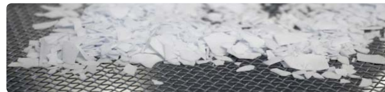
Tamis intégré : protection contre les corps étrangers pour une production vierge de toute impureté.
