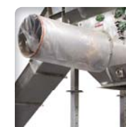
➤ Compacteur à vis pour l'évacuation des sacs vides et la réduction des émissions de poussières
