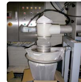
Ensachage en sortie de doseur à vis
