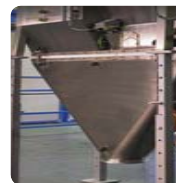
Goulotte statique inox pour le transfert des poudres lors du process
