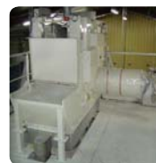
Trémie pour ajout d'additif : pré-pesée et demi-sacs
