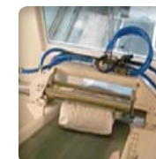
Pré-concassage des sacs lors du passage des sacs fortement pris en motte. Le passage du sac au niveau du capteur de présence actionne le martelage en boucle du sac
