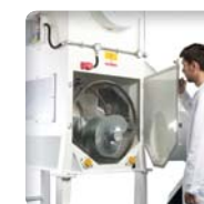
➤ Ouverture sur la vis de compactage
