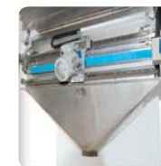
La goulotte vibrante permet de canaliser le flux produit pour l'introduction dans le process en amont
