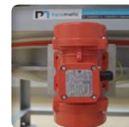
Moteur vibrant pour améliorer l'amplitude et l'intensité du tamis. Ces paramètres sont réglables en fonction de la coulabilité du produit et de la maille
