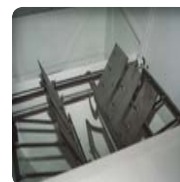
Parties mobiles internes à la machine assurant le secouage et l'éjection des sacs
