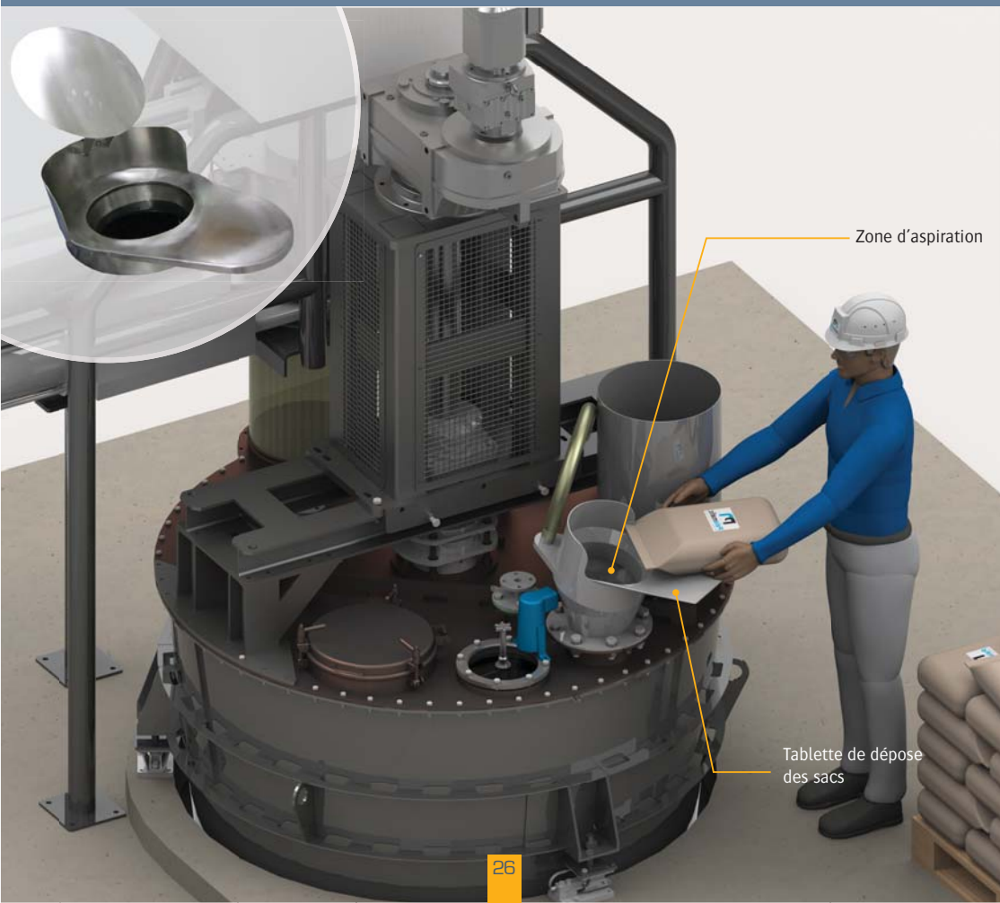
▶ Anneau simplifié pour l'aspiration sur le pourtour d'un mélangeur vertical
