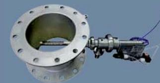
La prise d'échantillon est conçue de façon à ce que la matière prélevée reste confinée, sans contact avec l'air ambiant. Le prélèvement confiné permet également de garantir la sécurité des opérateurs.
