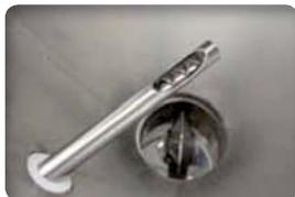
L'extrémité de la vis est située dans le flux de produit
