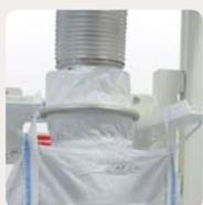
➤ Connexion étanche du big bag : pas de poussière, de corps étrangers et limite le zonage ATEX
