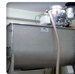
► Chargement transport pneumatique sur mélangeur en auge
