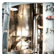
▶ Polissage des éléments soudés pour une finition hygiénique
