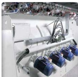
➤ Mélange multi-choppers pour l'incorporation du liquide à haut pourcentage
